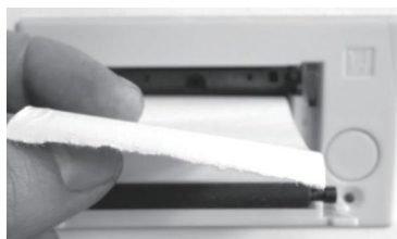
Abb. 6-11 Legen Sie die hintere Papierabdeckung auf die vordere Abdeckung.
