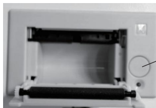
Abb. 6-9 Öffnen der vorderen Abdeckung des Druckers
